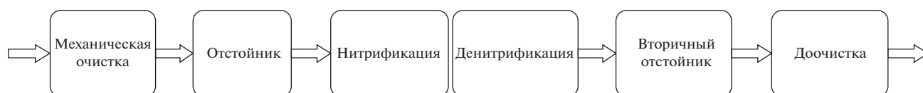
Рис. 2. Схема биологической очистки с удалением азота.
